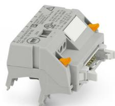
Adaptador V8 para 8 x PLC-INTERFACE (6,2 mm), control: Sistema de cableado PLC de tarjetas de salida, conexión 1: Conector macho IDC/FLK 1x 14-polos, conexión 2: Conexión enchufable (Encajable en 8x bornes PLC-INTERFACE), conexión 3: Conexión por tornillo 1x 2-polos, número de canales: 8, lógica de mando: minusschaltend
