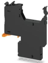
Adaptador de enchufe para fusibles para uso en una borna de base PLC de 6,2 mm. Para fusibles lentes 5 x 20 mm. Tensión de servicio: universal. Sin indicación de fallo de fusible.
