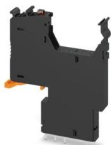
Adaptador de enchufe para fusibles para uso en una borna de base PLC de 6,2 mm. Para fusibles lentes 5 x 20 mm. Tensión de servicio: 12 ... 24 V AC/DC. Con LED para indicación de fallo de fusible.
