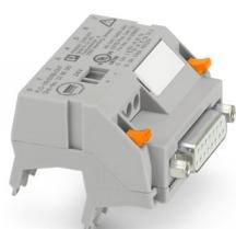
Adaptador V8 para 8 x PLC-INTERFACE (6,2 mm), control: Sistema de cableado PLC de tarjetas de salida, conexión 1: Hembra de conexión D-SUB 1x 15-polos, conexión 2: Conexión enchufable (Encajable en 8x bornes PLC-INTERFACE), conexión 3: Conexión por tornillo 1x 2-polos, número de canales: 8, lógica de mando: conmutación a positivo
