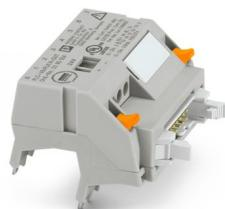
Adaptador V8 para 8 x PLC-INTERFACE (6,2 mm), control: Sistema de cableado PLC de tarjetas de salida, conexión 1: Conector macho IDC/FLK 1x 14-polos, conexión 2: Conexión enchufable (Encajable en 8x bornes PLC-INTERFACE), conexión 3: Conexión por tornillo 1x 2-polos, número de canales: 8, lógica de mando: conmutación a positivo
