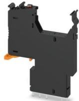
Adaptador de enchufe para fusibles para uso en una borna de base PLC de 6,2 mm. Para fusibles lentos 5 x 20 mm. Tensión de servicio: 120 ... 230 V AC/DC. Con LED para indicación de fallo de fusible.
