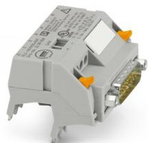
Adaptador V8 para 8 x PLC-INTERFACE (6,2 mm), control: Sistema de cableado PLC de tarjetas de salida, conexión 1: Conector macho D-SUB 1x 15-polos, conexión 2: Conexión enchufable (Encajable en 8x bornes PLC-INTERFACE), conexión 3: Conexión por tornillo 1x 2-polos, número de canales: 8, lógica de mando: conmutación a positivo
