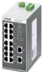
Ethernet Switch, 16 puertos TP-RJ45, registro automático de la velocidad de transmisión de datos de 10 ó 100 Mbits/s (RJ45), función Autocrossing
