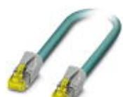
Cable de parcheo, CAT6<sub>A</sub>, 4 pares, apantallado, conexión no cruzada (Line), confeccionado a ambos lados con conectores enchufables RJ45/IP20, material de la envoltura exterior: PUR, longitud: 2,0 m
