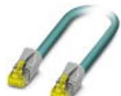
Cable de parcheo, CAT6<sub>A</sub>, 4 pares, apantallado, conexión no cruzada (Line), confeccionado a ambos lados con conectores enchufables RJ45/IP20, material de la envoltura exterior: PUR, longitud: 3,0 m
