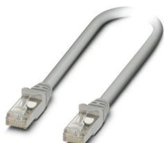
Cable patch, índice de protección: IP20, longitud de cable: 2 m, número de polos: 8, CAT5, tipo de conexión: Conexión Pierce, sección de conexión: AWG 26- 26, salida de cables: recta, Ethernet
