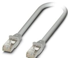
Cable patch, índice de protección: IP20, longitud de cable: 1 m, número de polos: 8, CAT5, tipo de conexión: Conexión Pierce, sección de conexión: AWG 26- 26, salida de cables: recta, Ethernet
