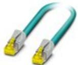
Cable de parcheo, CAT6<sub>A</sub>, 4 pares, apantallado, conexión no cruzada (Line), confeccionado a ambos lados con conectores enchufables RJ45/IP20, material de la envoltura exterior: PUR, longitud: 2,0 m
