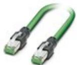
Cable patch, índice de protección: IP20, longitud de cable: 5 m, número de polos: 4, 100 MBit/s, CAT5, material: PA 6.6, PROFINET
