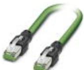
Cable de parcheo PROFINET, apantallado, cuadrete en estrella, AWG 22 flexible (7 hilos), verde, conector RJ45/IP20, recto, sobre conector macho RJ45/IP20, recto, longitud: 5 m
