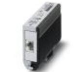
Protección contra sobretensiones según clase E<sub>A</sub> (CAT.6<sub>A</sub>), para Ethernet Gigabit (hasta 10 GBit/s), Token Ring, FDDI/CDDI, ISDN, DS1. Adecuada para Power over Ethernet (PoE+) "Modo A" y "Modo B". Conector intermedio RJ45 con conductor de puesta a tierra por separado y pie de encaje de puesta a tierra para carril NS 35.
