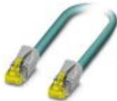
Cable patch, índice de protección: IP20, número de polos: 8, 10 GBit/s, CAT6A, salida de cables: recta
