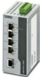
Ethernet Switch con PoE+, de conformidad con la especificación IEEE 802.3at. Comprende cuatro puertos de tipo PoE+ y un puerto RJ45 estándar, todos con velocidades de 10/100 MBit/s.
