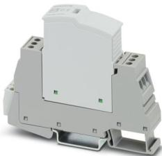
Protección contra sobretensiones de tipo 3, formada por protección enchufable y elemento de base, con indicador de estado e indicación remota integrados para redes de fuente de alimentación monofásicas. Tensión nominal: 60 V AC/DC
