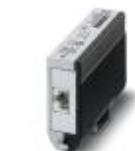
Protección contra sobretensiones según clase E<sub>A</sub> (CAT.6<sub>A</sub>), para Ethernet Gigabit (hasta 10 GBit/s), Token Ring, FDDI/CDDI, ISDN, DS1. Adecuada para Power over Ethernet (PoE+) "Modo A" y "Modo B". Conector intermedio RJ45 con conductor de puesta a tierra por separado y pie de encaje de puesta a tierra para carril NS 35.
