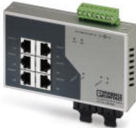
Ethernet Switch, 6 puertos TP-RJ45, 2 puertos de fibra óptica, 100 Mbits/s dúplex completo en formato SC-D, registro automático de la velocidad de transmisión de datos de 10 ó 100 Mbits/s (RJ45), función Autocrossing
