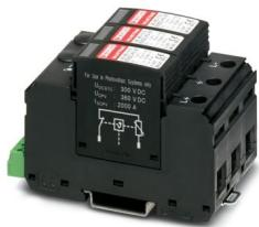
Dispositivo de protección contra sobretensiones / corrientes de rayo para sistemas fotovoltaicos de tensión continua aislados y puestos a tierra de 600 V DC y 2 polos, para montaje sobre carril DIN, elemento de base de 3 polos con contacto de indicación remota, tres elementos de protección enchufables con monitorización de temperatura, mensaje de estado en cada conector.
