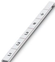
Marcador para bornes, Tiras, blanco, rotulado, longitudinal: L1, L2, L3, N, GND, clase de montaje: enclavar, para ancho de borne: 18 mm, Número de índices individuales: 5, altura del campo de texto: 5 mm, anchura del campo de texto: 18 mm
