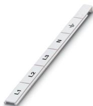
Marcador para bornes, Tiras, blanco, rotulado, longitudinal: L1, L2, L3, N, GND, clase de montaje: enclavar, para ancho de borne: 18 mm, Número de índices individuales: 5, altura del campo de texto: 5 mm, anchura del campo de texto: 18 mm
