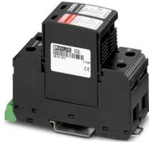
Descargador de corrientes de rayo / sobretensiones enchufable universal equipado con varistores para redes monofásicas de alimentación de corriente con N y PE separados (sistema de 3 conductores: L1, N, PE), con contacto de indicación remota.
