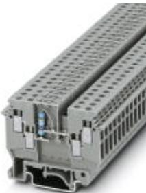
Borne para componentes, tensión nominal: 630 V, corriente nominal: 32 A, tipo de conexión: Conexión por tornillo, número de conexiones: 4, sección: 0,2 mm<sup>2</sup> - 6 mm<sup>2</sup>, AWG: 24 - 10, anchura: 6,2 mm, color: gris, clase de montaje: NS 35/7,5, NS 35/15, NS 32
