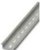
Carril simétrico perforado, Perfil estándar, anchura: 35 mm, altura: 7,5 mm, según EN 60715, material: Acero, galvanizado, pasivado de capa gruesa, longitud: 2000 mm, color: plata
