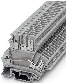
Borne de paso, tipo de conexión: Conexión por tornillo, Conexión de enchufe plano, sección: 0,2 mm<sup>2</sup> - 4 mm<sup>2</sup>, AWG: 24 - 12, anchura: 6,2 mm, color: gris, montaje: NS 35/7,5, NS 35/15, NS 32
