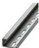
Carril simétrico perforado, Perfil G, anchura: 32 mm, altura: 15 mm, según EN 60715, material: Acero, galvanizado, pasivado de capa gruesa, longitud: 2000 mm, color: plata
