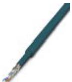
Cable CAT5-SF/UTP (J-02YS(ST)C HP 2 x 2 x 24 AWG), cable de instalación robusto 2 x 2 x 0,22 mm<sup>2</sup>, conductor rígido, apantallado, envoltura exterior: Diámetro 7,8 mm, envoltura interior: Diámetro 5,75 mm ± 0,15 mm, confeccionado en ambos extremos con conector RJ45, crossover (cruzado) o line (no cruzado)
