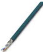
Cable CAT5-SF/UTP (J-LI02YS(ST)C H 2 x 2 x 26 AWG), cable de instalación ligero, flexible 2 x 2 x 0,14 mm<sup>2</sup>, flexible, apantallado, envoltura exterior: Diámetro 5,75 mm ± 0,15 mm, confeccionado en ambos extremos con conector RJ45, ocupación crossover (cruzado) o line (no cruzado)
