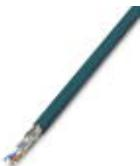
Cable CAT5-SF/UTP (J-LI02YS(ST)C H 2 x 2 x 26 AWG), cable de instalación ligero, flexible 2 x 2 x 0,14 mm<sup>2</sup>, flexible, apantallado, envoltura exterior: Diámetro 5,75 mm ± 0,15 mm
