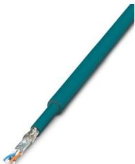
Cable CAT5-SF/UTP (J-02YS(ST)C HP 2 x 2 x 24 AWG), cable de instalación robusto 2 x 2 x 0,22 mm<sup>2</sup>, conductor rígido, apantallado, envoltura exterior: Diámetro 7,8 mm, envoltura interior: Diámetro 5,75 mm ± 0,15 mm, confeccionado en ambos extremos con conector RJ45, crossover (cruzado) o line (no cruzado)
