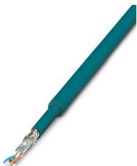
Cable CAT5-SF/UTP (J-02YS(ST)C HP 2 x 2 x 24 AWG), cable de instalación robusto, 2 x 2 x 0,22 mm<sup>2</sup>, conductor rígido, apantallado, envoltura exterior: Diámetro 7,8 mm, envoltura interior: Diámetro 5,75 mm ± 0,15 mm
