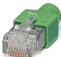
Conector enchufable RJ45, diseño: RJ45, índice de protección: IP20, número de polos: 8, 1 GBit/s, CAT5 (IEC 11801:2002), material: Plástico, tipo de conexión: Conexión crimpada, sección de conexión: AWG 26- 24, salida de cables: recta, color: verde, Ethernet
