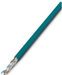
Cable CAT5-SF/UTP (J-LI02YS(ST)C H 2 x 2 x 26 AWG), cable de instalación ligero, flexible 2 x 2 x 0,14 mm<sup>2</sup>, flexible, apantallado, envoltura exterior: Diámetro 5,75 mm ± 0,15 mm, confeccionado en ambos extremos con conector RJ45, ocupación crossover (cruzado) o line (no cruzado)
