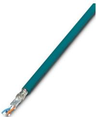
Por metros, Cable de instalación, Ethernet CAT5 (100 MBit/s), apantallado, PUR sin halógenos, azul agua RAL 5021, 4-conductores (2x2xAWG26/7, SF/UTP), color conductores individuales: blanco/naranja-naranja, blanco/verde-verde, longitud de cable: Libre entrada (1,0 ... 1000,0 m)
