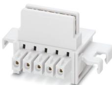
Conectores de bus para carril, color: gris claro, corriente nominal: 8 A (contactos paralelos), tensión nominal (III/2): 125 V, número de polos: 5, familia de artículos: TBUS5-17,5.., paso: 3,81 mm, montaje: Montaje sobre carril DIN, bloqueo: sin, tipo de fijación: sin, tipo de embalaje: empaquetado en caja, Artículos con contactos dorados, conectores de bus para la conexión con cajas para electrónica, 5 contactos en paralelo
