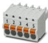
Conector para placa de circuito impreso, corriente nominal: 8 A, tensión de dimensionamiento (III/2): 160 V, sección nominal: 1,5 mm<sup>2</sup>, número de polos: 5, paso: 3,81 mm, tipo de conexión: Conexión por resorte push-in, color: gris claro, superficie contactos: Estaño
