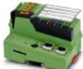
El controlador Inline ofrece la posibilidad de comunicar mediante PROFINET y Modbus/TCP. La programación se realiza con PC Worx Express o PC Worx (IEC 61131-3).
