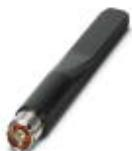
Antena omnidireccional, 2,4 GHz/5 GHz, ganancia: 2,5 dBi/5 dBi, polarización: lineal, ángulo de apertura: h/v 360°/30°/16°, índice de protección: IP68, conexión: N (macho), cable de conexión adecuado para pasamuros de armario de control (código 2701402)
