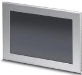
Panel táctil con 30,7 cm / 12,1"-TFT-pantalla (analógico-resistivo (poliéster)), 1280 x 800 píxel(es) (WXGA), 65536 colores, Arm® Cortex®-A8, 800 MHz, 2x USB Host 2.0, 1x Ethernet (10/100 MBit/s), RJ45, Windows® Embedded Compact 7 y software de usuario: Visu+ / AX OPC Server. (sistema bus: sin)
