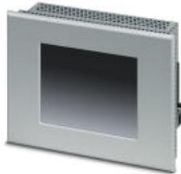
Panel táctil con 14,5 cm / TFT de 5,7"-pantalla (analógico-resistivo (poliéster)), 320 x 240 píxel(es) (QVGA), 65536 colores, Arm® Cortex®-A8, 800 MHz, 2x USB Host 2.0, 1x Ethernet (10/100 MBit/s), RJ45, Windows® Embedded Compact 7 y software de usuario: Visu+ / AX OPC Server. (sistema bus: sin)
