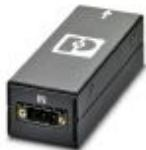
El PC-PWR-FLTR-2 acumula la potencia entrante hasta que se ha alcanzado la tensión de servicio. Para la utilización con fuentes de tensión de 24 V DC con tiempo de ascenso superior a 100 ms con un máximo de 7 A.
