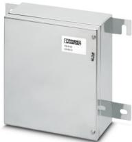
Caja de distribución de acero de ley en campo con 9 conexiones para el uso en una zona Ex. Incluye módulo de cable principal FB-ET, base Plugtrab con alojamiento para protección enchufable contra sobretensiones y espacio en el carril simétrico para 6 acopladores de dispositivos.
