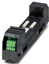
Portante para conector de alimentación de tensión de bus de campo. Con redundancia cuando se hayan instalado 2 conectores. La redundancia se mantiene mediante los buses de energía internos a través de varios portantes. Otro bus interno posibilita la indicación remota.
