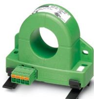
Convertidor de corriente universal para la medición de corrientes continuas, alternas y distorsionadas, corriente de entrada 0 ... 100 A, salida 0 ... 10 V
