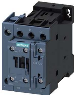
Contactor de potencia, AC-3 25 A, 11 kW/400 V 2 NA + 2 NC 24 V DC 4 polos tamaño S0 conexión por tornillo 1 NA + 1 NC integrados
