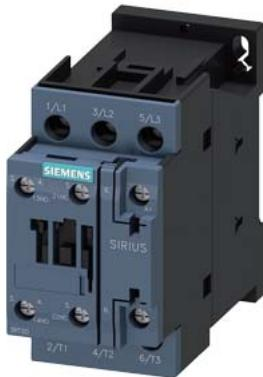
Contactor de potencia, AC-3 25 A, 11 kW/400 V 1 NA + 1 NC, 110 V AC, 50 Hz, 120 V, 60 Hz, 3 polos, tamaño S0, conexión por tornillo
