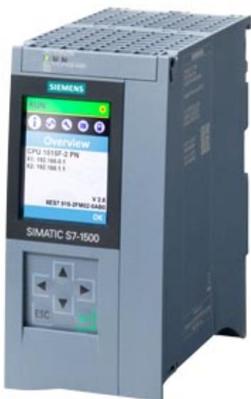
SIMATIC S7-1500F, CPU 1515F-2 PN, módulo central con memoria de trabajo de 750 kB para programas y 3 Mbytes para datos, 1.<sup>a</sup> interfaz: PROFINET IRT con switch de 2 puertos, 2.<sup>a</sup> interfaz: PROFINET RT, 30 ns rendimiento bits, SIMATIC Memory Card necesaria
