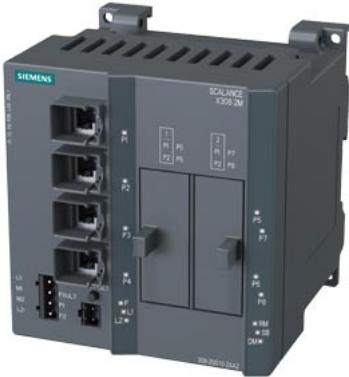
SCALANCE X308-2M; managed IE Switch, compacto; 4x 10/100/1000 Mbit/s para puertos RJ45 eléctricos; 2 x 100/1000 Mbit/s para módulos de medio de 2 puertos, eléctricos u ópticos; diagnóstico LED; contacto de señalización contacto; pulsador SELECT/SET; Dispositivo PROFINET IO; gestión gestión; administrador de redundancia integrado; Office características (RSTP, VLAN, IGMP,...); C-PLUG en el volumen de suministro
