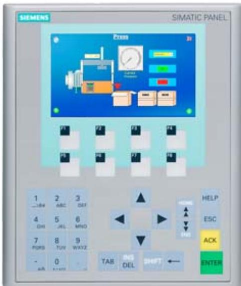
SIMATIC HMI KP400 Basic Color PN, Basic Panel, mando por teclado, pantalla TFT widescreen de 4", 256 colores, Interfaz PROFINET, configurable a partir de WinCC Basic V11 SP2/ STEP 7 Basic V11 SP2, incluye software Open Source, que se cede gratuitamente ver CD adjunto
