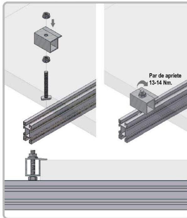
Unión de grapas de panel a perfil correa mediante tornillo de cabeza de martillo y tuerca de collar biselado permitiendo su movimiento deslizante dentro del carril guía hasta el correcto posicionamiento del panel. A continuación efectuar el par de apriete.
