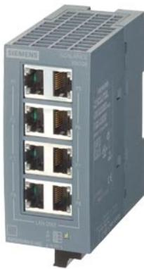
SCALANCE XB008 unmanaged Industrial Ethernet Switch para 10/100 Mbit/s; para configurar pequeñas topologías en estrella y en línea; diagnóstico LED, IP20, 24 V AC/DC fuente de alimentación, con 8 10/100 Mbit/s Twisted Pair Ports con conectores hembra RJ45; manual disponible para su descarga .
