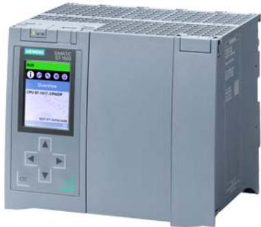
SIMATIC S7-1500, CPU 1517-3 PN/DP, módulo central con memoria de trabajo de 2 MB para programa y 8 MB para datos, 1.<sup>a</sup> interfaz: PROFINET IRT con switch de 2 puertos, 2.<sup>a</sup> interfaz: PROFINET RT, 3.<sup>a</sup> interfaz: PROFIBUS, rendimiento bits 2 ns, se necesita SIMATIC Memory Card
