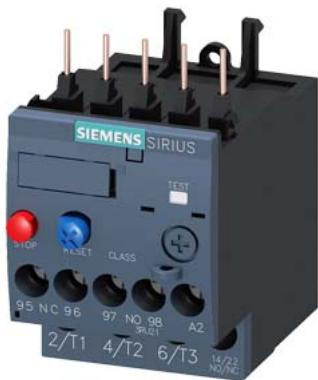
Relé de sobrecarga 1,8...2,5 A térmico para protección de motores tamaño S00, clase 10 para montar en contactor Circuito principal: atornillable Circuito auxiliar: atornillable Rearme manual/automático
