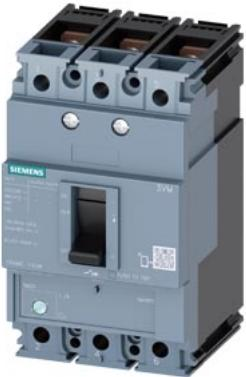
Interruptor automático 3VM1 IEC Frame 160 Clase de poder de corte M Icu=55kA @ 415V 3 polos, protección de distribuciones TM220, ATFM, In=40 A protección de sobrecarga Ir=28A...40A protección de cortocircuito Ii=10 x In conexión plana con tornillos
