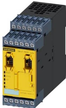
módulo digital de seguridad DM-F PROFIsafe para desconexión de seguridad vía Bus/PROFIsafe, US: 110...240 V AC/DC, 2 circuitos de habilitación por relés, 2 salidas de relé, 3 entradas, SIL máx. alcanzable IEC 61508: 3, PL máx. alcanzable ISO 13849-1: E
