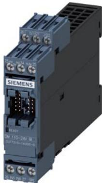
Módulo digital, 4 entradas y 2 salidas de relé, tensión de entrada 110-240 V AC/DC salidas de relé biestables, máx. 2 módulos digitales, para unidad base SIMOCODE pro V,
