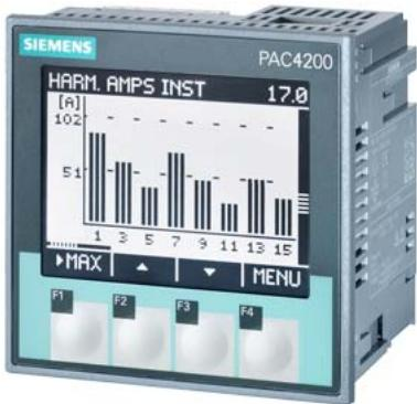
SENTRON, instrumento de medida, 7KM PAC4200, LCD, L-L: 690 V, L-N: 400 V, 5 A, trifás., Modbus TCP, opcional Modbus RTU / PROFINET/PROFIBUS/DI/DO, energía aparente/activa/reactiva /cos phi, armónicos: 2. - 64., THD, clase 0,2 según IEC61557-12 o bien clase 0,2S según IEC62053-22, fuente de rango amplio de entrada, AC/DC, borne de tornillo
