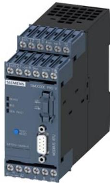
Unidad base SIMOCODE pro V MR, interfaz MODBUS RTU 57,6 kbits/s, RS-485, 4E/3S libremente parametrizables, US: 110...240 V AC/DC, entrada para termistor salidas de relé monoestables, ampliable mediante módulos de ampliación
