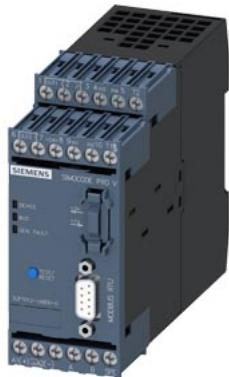
Unidad base SIMOCODE pro V MR, interfaz MODBUS RTU 57,6 kbits/s, RS-485, 4E/3S libremente parametrizables, US: 24 V DC, entrada para termistor salidas de relé monoestables, ampliable mediante módulos de ampliación
