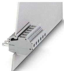
Borne de paso, tipo de conexión: Conexión por tornillo con cápsula de tracción, Conexión de soldadura/enchufe plano, número de polos: 1, corriente de carga: 18 A, sección: 0,2 mm<sup>2</sup> - 6 mm<sup>2</sup>, dirección de conexión del conductor con respecto a la dirección de enchufe: 90 °, anchura: 6,15 mm, color: gris
