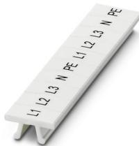
Tira de cinta Zack, Tiras, blanco, rotulado, longitudinal: L1, L2, L3, N, PE, L1, L2, L3, N, PE, clase de montaje: enclavar, para ancho de borne: 5,2 mm, Número de índices individuales: 10, altura del campo de texto: 10,5 mm, anchura del campo de texto: 5,15 mm
