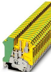
Borna de tierra, tipo de conexión: Conexión por tornillo, 1er piso, sección: 0,2 mm<sup>2</sup> - 4 mm<sup>2</sup>, clase de montaje: NS 35/7,5, NS 35/15, NS 32, color: amarillo-verde
