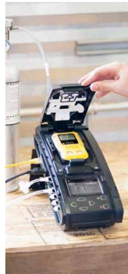
IntelliDoX combina los módulos de acoplamiento inteligentes con nuestro sistema de gestión de instrumentos para proporcionar pruebas y registros automatizados de todos los detectores Honeywell BW™ Clip4.
