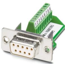
Inserto de contactos D-SUB, tamaño de envoltura 1, con 9 contactos de señal, tipo de conexión del contacto: hembra, conexión por tornillo, recto, para marcos empotrados y carcasa aéreas en índice de protección IP67
