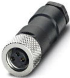
Conector, Universal, 3-polos, Hembra de conexión recta M8, Codificación: A, Conexión por soldadura, material de moleteado: Latón, niquelado, diámetro exterior del cable 3,5 mm ... 5 mm
