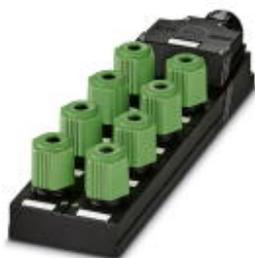
Caja de sensores/actuadores, aplicación: Estándar, tipo de conexión: QUICKON, 0,34 mm<sup>2</sup> ... 0,75 mm<sup>2</sup>, número de puestos enchufables: 8, número de polos: 4, ocupación de los puestos enchufables: simple, indicación de estado: Sí, pnp; conexión de cable principal: Conexión por resorte 180°, apantallamiento: no
