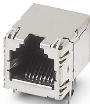
Conector para placa de circuito impreso RJ45, diseño: RJ45, índice de protección: IP20, número de polos: 8, 1 GBit/s, CAT5 (IEC 11801:2002), material: Metal, tipo de conexión: Soldadura por ola THT, salida de cables: recta
