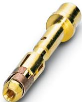
Contacto crimpado, Hembra, mecanizado, Contacto individual, diámetro de contacto: 1 mm, margen para engaste: 0,25 mm<sup>2</sup> ... 1 mm<sup>2</sup>, Producto alternativo según RoHS II sin excepción 6c (Pb < 0,1 %) código de art.: 1241922
