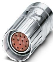
M23, Conector para cables, serie: CA, recto, apantallado: sí, Bloqueo por tornillo, Nº de polos: 12, Sentido de giro: Movimiento contrario, tipo de conexión del contacto: Hembra, Conexión crimpada, rango de diámetro de cable: 3 mm ... 14,5 mm, codificación: N, Producto alternativo según RoHS II sin excepción 6c (Pb < 0,1 %) código de art.: 1243722
