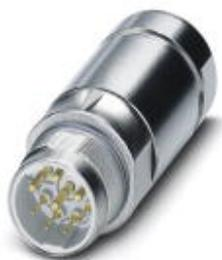
Conector enchufable de acoplamiento, recto largo, para bloqueo estándar y SPEEDCON, M23, número de polos: 5+PE, tipo de contacto: Pin, Conexión engastada, apantallado: sí, rango de diámetro de cable: 7,5 mm ... 18 mm, Compatible con contraconectores con tuerca moleteada SPEEDCON o M23 estándar
