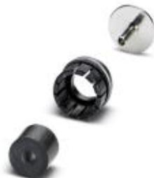
Empaquetadura de fijación del cable y adaptador de pantalla, apantallado: sí, diámetro del haz de hilos trenzados: 4,1 mm, rango de diámetro de cable: 5,5 mm ... 6,5 mm
