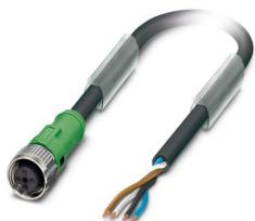
Cable para sensores/actuadores, 4-polos, PUR, negro grisáceo RAL 7021, extremo de cable libre, a Hembra recta M12 SPEEDCON, codificación: A, longitud de cable: 5 m
